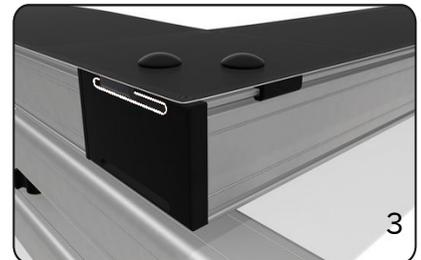
●図4の順にクリップを縦・横方向の順にフレームの溝に掛けていきます。
